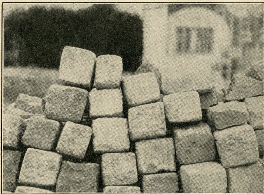
1. kép. Gránit-kockakövek. A kőzet szemcsés szövete és a kockák élleinek, csúcsainak legömbölyödöttsége jól megfigyelhető. (A szerző eredeti felvétele.)
