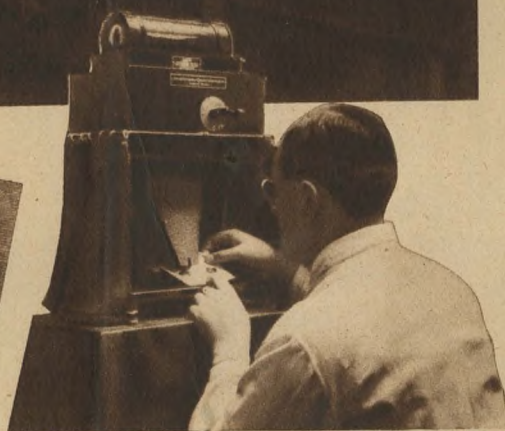
A főkapitányság laboratóriumában a többi nagyszerű műszerek között kvarclámpával vizsgálják egy hamisított levelet
