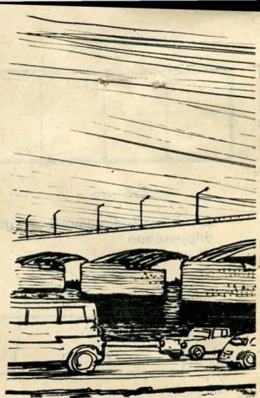
5: ábra. Egy épülő feszített betonhid oldalról nézve. (A pillér megépítése után a pillér feletti szélesebb szakaszt a helyszínen készítik el, majd a hidpálya előregyártott elemeit – a két oldalon azonos ütemben – illesztik a helyükre)
